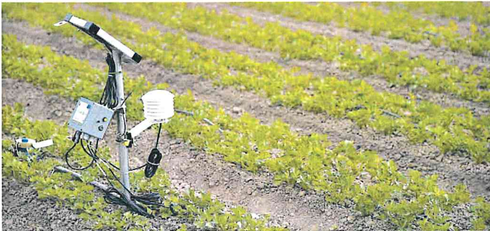
Sonda para el control de la humedad, instalada en una parcela del Campo de Cartagena.
